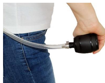
Operación con minibomba de aire como equipo a presión
